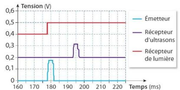
Calculer la célérité du signal de mesure. Confirmer que le télémètre utilise des ultrasons pour mesurer la distance.
